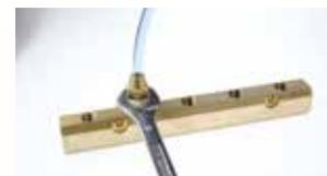
Visser l'écrou à la clé, afin d'obtenir le sertissage de la bague sur le tube ; le raccordement est réalisé quand le couple de serrage conseillé est atteint (voir tableaux ci-dessous).
