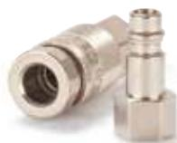
Ce coupleur a été spécialement développé pour les appareils respiratoires. Connexion d'une seule main. Clapet High Flow pour un débit optimal et une faible perte de charge. Système de verrouillage de sécurité empêchant toute déconnexion involontaire. Pour la déconnexion, l'embout doit être d'abord poussé vers l'intérieur du coupleur. Testé selon la norme DIN EN 14593.
