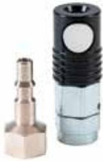
Coupleur de sécurité avec système de purge automatique pour profil ISO 6150 C. La purge automatique a lieu lors de la déconnexion - aucun risque d'effet coup de fouet des tuyaux sous pression. Lorsque l'on appuie sur le bouton-poussoir pour la première fois, l'air est évacué du coupleur, mais l'embout du coupleur reste verrouillé. Il n'est déconnecté que lorsque le bouton-poussoir est actionné pour la deuxième fois.
