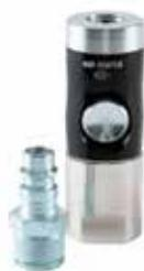
Coupleur de sécurité avec système de purge automatique pour profil Euro. La purge automatique a lieu lors de la déconnexion - aucun risque d'effet coup de fouet des tuyaux sous pression. Lorsque l'on appuie sur le bouton-poussoir pour la première fois, l'air est évacué du coupleur, mais l'embout du coupleur reste verrouillé. Il n'est déconnecté que lorsque le bouton-poussoir est actionné pour la deuxième fois.
