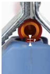
1. Placer le tube dans l'outil de dégainage pour ajuster la hauteur de la lame à l'épaisseur du tube.
