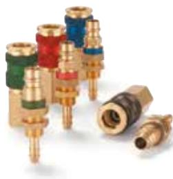
Coupleur industriel à codage développé sur la base de la série 25. Connexion d'une seule main. Clapet High Flow pour un débit optimal et une faible perte de charge. Le codage mécanique du coupleur et de l'embout permettent d'identifier les fluides lors de la connexion, tout comme le codage couleur des coiffes anodisées.
