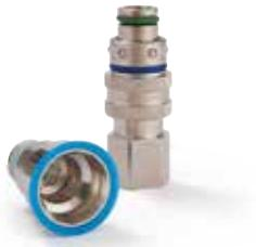
Les coupleurs Parker Rectus séries 608, 612 (série française) sans obturation ont été spécialement développés pour connecter les lignes de refroidissement des moules. L'insertion de l'embout mâle dans le moule évite les risques de blessure et d'accrochage du moule lors des manipulations.
