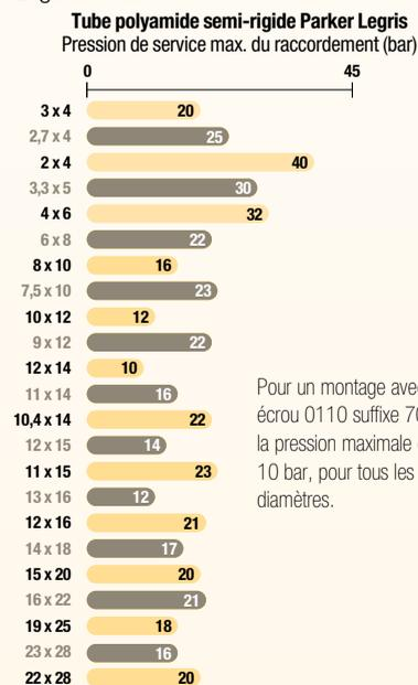
Pour un montage avec un écrou 0110 suffixe 70, la pression maximale est de 10 bar, pour tous les diamètres.
