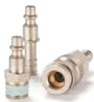
Coupleur industriel 1/4" pour un débit optimal, conforme aux normes ISO 6150 B et US Mil. Spec. 4109. Particulièrement adapté pour une utilisation avec des fluides gazeux dans l'industrie. Variantes spéciales avec clapet en laiton pour une utilisation avec des liquides. Hautes performances de débit avec une faible perte de charge et de multiples possibilités de raccordement.
