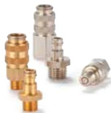
Mini coupleur industriel du profil le plus utilisé dans le monde dans ce diamètre nominal. Performances de débit supérieures à la moyenne pour les fluides liquides et gazeux. Doté d'un système de verrouillage de sécurité empêchant toute déconnexion involontaire. Pour la déconnexion, l'embout doit d'abord être poussé à l'intérieur du coupleur. Version laiton sans nickelage et avec d'autres connexions de tubes disponibles sur demande.
