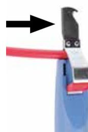
5. Déplacer l'outil vers l'extrémité du tube pour réaliser une ouverture axiale de la gaine.
