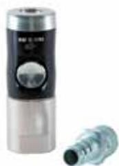
Coupleur de sécurité avec système de purge automatique pour profil ISO 6150 B. La purge automatique a lieu lors de la déconnexion - aucun risque d'effet coup de fouet des tuyaux sous pression. Lorsque l'on appuie sur le bouton-poussoir pour la première fois, l'air est évacué du coupleur, mais l'embout du coupleur reste verrouillé. Il n'est déconnecté que lorsque le bouton-poussoir est actionné pour la deuxième fois.
