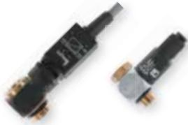
Les raccords capteurs émettent un signal pneumatique ou électrique dès que la pression de la chambre d'échappement du vérin descend en dessous de son seuil de pilotage.
