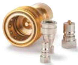
Coupleur de 1/8" à 1" avec embout conforme à la norme ISO 7241-1 série B. Particulièrement adapté à une utilisation avec des liquides. La connexion / déconnexion doit se faire des deux mains. Ces coupleurs se distinguent par leur débit élevé et une faible perte de charge.
