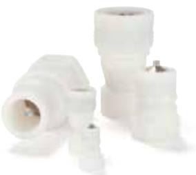
Coupleurs 1/8" à 1" avec profil d'embout conforme à la norme ISO 7241-1 série B. Particulièrement adapté pour une utilisation avec des fluides liquides. Système de connexion à commande bi-manuelle, la douille de verrouillage doit être repoussée manuellement lors de la connexion. Cette série se distingue par des débits élevés et une faible perte de charge.
