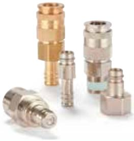
Coupleur universel 1/2" de profil européen standard pour applications pneumatiques. Connectable d'une seule main. Clapet High Flow pour un débit optimal et une faible perte de charge. La série se distingue par sa conception robuste (coiffe en acier), son débit extrêmement élevé et sa longue durée de vie, même en cas d'utilisation intensive. La conception de la coiffe minimise les dommages sur le corps du clapet.
