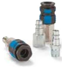
Coupleur industriel 3/8" de profil standard européen. Convient aux applications d'air comprimé avec une consommation d'air supérieure à la moyenne. Utilisable d'une seule main. Clapet Ultra High Flow pour un débit optimal et une faible perte de charge. Coiffe en plastique à 2 composants, extrêmement robuste et ergonomique.
