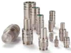
Coupleurs anti-pollution sans mécanisme de verrouillage, en acier inoxydable. Disponibles en cinq tailles différentes pour assemblage de plaque / presse modulaire dans les environnements sensibles. Différentes tailles de coupleurs peuvent être combinées à un coupleur multiple en fonction des exigences de l'application.
