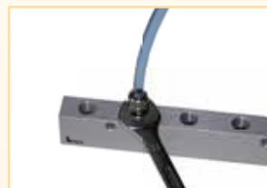
Visser l'écrou à fond, à la main (dans le cas d'un tube souple) et à la clé (dans le cas d'un tube semi-rigide) jusqu'au contact avec le corps.
