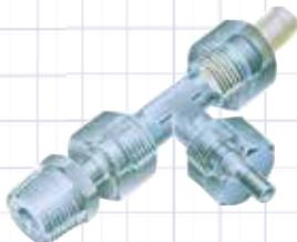
Raccordement et étanchéité réalisés par le sertissage d'une bague métallique sur un tube. Les étanchéités sont métal / métal
